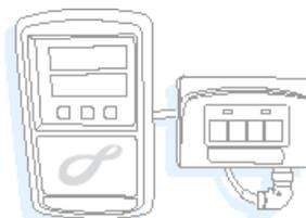
每個八達通讀寫器均連接商戶終端機 / 控制器，並按照終端機 / 控制器的指示作出相關交易（如扣款或現金增值）。視乎讀寫器的類別，有關交易資料會暫存於讀寫器內或傳送至商戶終端機 / 控制器。不論是何種操作方式，所有交易資料均會於每個工作天完結時傳送至八達通中央電腦系統進行處理及結算。
